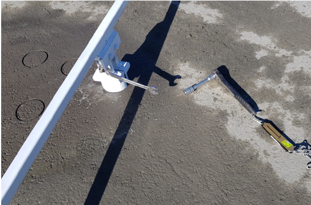
Bild 2.1 Version 1 av verktyg för att lossa och lyfta upp borrhärnan
